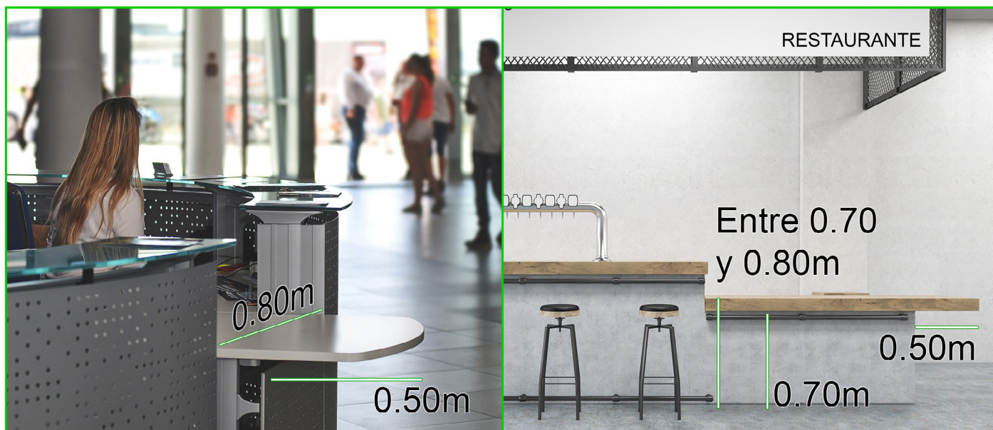
Imagen 11: Recepción y restaurante con mostrador a doble altura.
